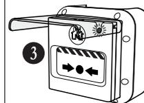
To activate a Fire alarm, press the flexible element in the middle - red LED is ON./ За да подадете сигнал за Тревога, натиснете работния елемент в средата - червения светодиод светва.
