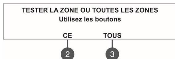
Le système exigera une confirmation soit que le test s'applique uniquement à la zone sélectionnée (touche (2) CE), soit qu'il s'applique à toutes les zones du système (touche (3) TOUS). L'état de la zone change en mode TEST, permettant le test de la fonctionnalité des dispositifs dans la zone. La LED « Test » s'allume en fixe.
